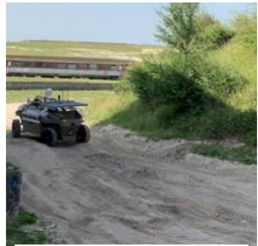
Figure 9: Robot Véhicule FURIOUS, après une phase de franchissement en autonomie totale durant les essais opérationnels au CENZUB.
