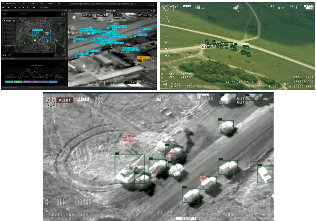
Figure 4: Détection automatique de cibles par apprentissage profond, intégrée à bord de drones
